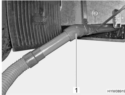
Fig. 144 Tubo de salida con manguera de aguas residuales
