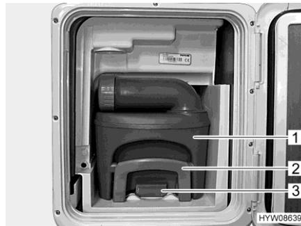
Fig. 149 Depósito de aguas fecales (en el vehículo)
