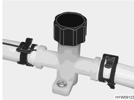
Fig. 151 Llave de desagüe (tubería de agua)
