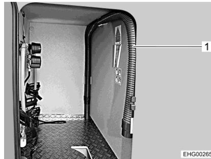
Fig. 142 Manguera de aguas residuales (caja para bombonas de gas)
