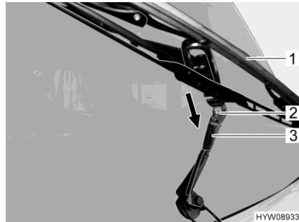
Fig. 157 Cambiar hoja de limpiaparabrisas
