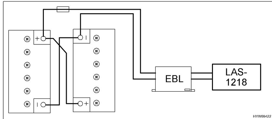
Fig. 101 Conectar la batería adicional
