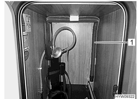
Fig. 143 Manguera de aguas residuales (dispositivo de extracción de caja para bombonas de gas)
