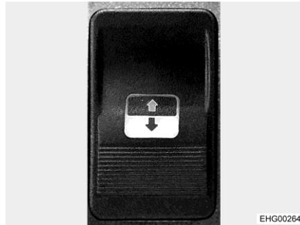
Fig. 19 Interruptor (elevelunas eléctrico en la puerta del conductor)
