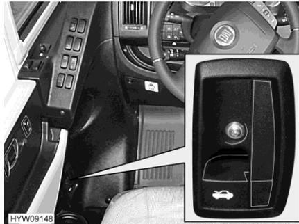
Fig. 23 Palanca de desbloqueo (capó del motor)
