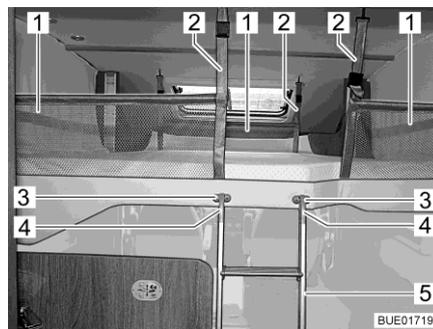
Fig. 74 Cama elevada con red de seguridad tendida
