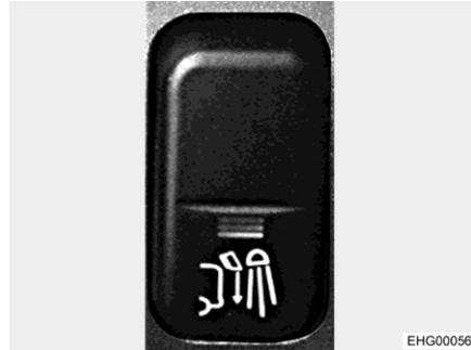
Fig. 30 Interruptor basculante (iluminación de la zona posterior)
