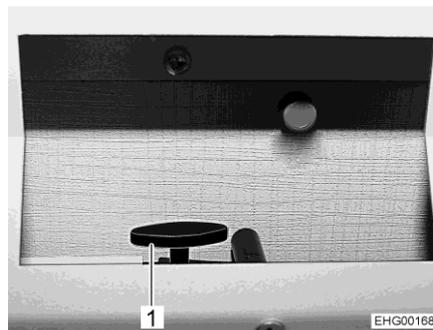
Fig. 118 Válvula reductora (abierta)
