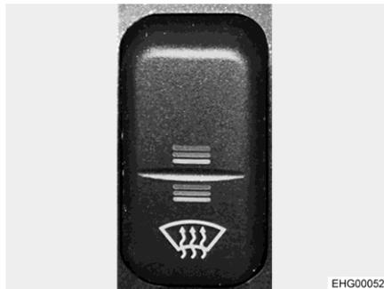
Fig. 11 Interruptor basculante (calefacción de la luna delantera)
