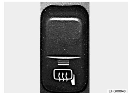
Fig. 21 Interruptor (calefacción de los retrovisores)
