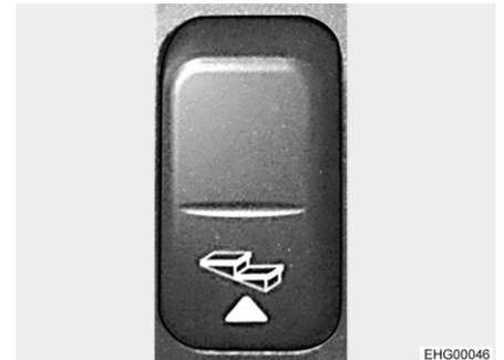
Fig. 10 Interruptor basculante para el escalón de entrada (salpicadero)
