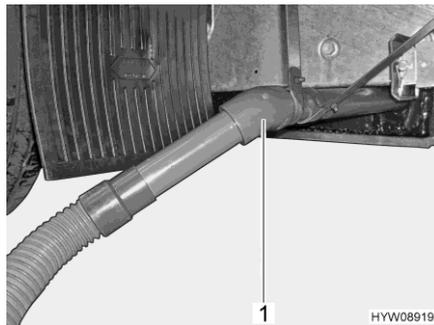
Fig. 144 Tuyau de purge avec tuyau d'évacuation des eaux usées
