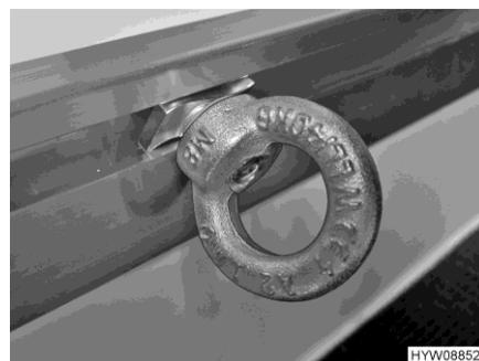
Fig. 6 Œillet de serrage (déplaçable)
