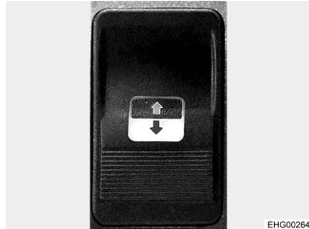
Fig. 19 Commutateur (lève-vitre électrique dans la porte chauffeur)
