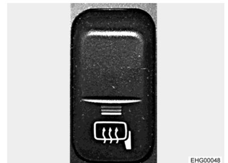
Fig. 21 Commutateur (chauffage du rétroviseur)
