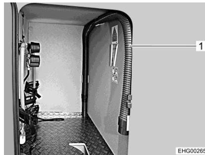
Fig. 142 Tuyau d'évacuation des eaux usées (compartiment à gaz)
