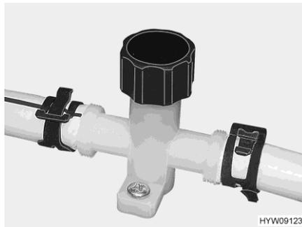
Fig. 151 Robinet de vidange (conduite d'eau)
