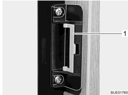
Fig. 135 Dispositif de fermeture (position normale)
