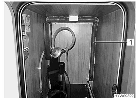
Fig. 143 Tuyau d'évacuation des eaux usées (extension du compartiment à gaz)
