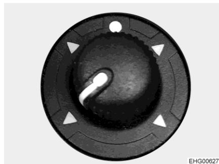
Fig. 20 Commutateur (rétroviseurs extérieurs à réglage électrique)
