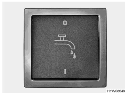
Fig. 137 Interrupteur (pompe à eau)
