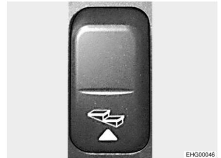
Fig. 10 Commutateur à bascule pour le marchepied (tableau de bord)
