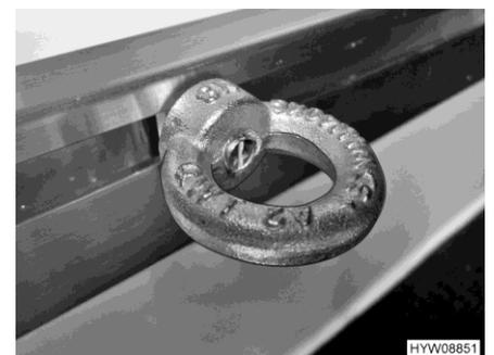
Fig. 7 Œillet de serrage (bloqué)
