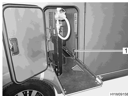
Fig. 93 Extension du compartiment à gaz en position de changement de bouteille
