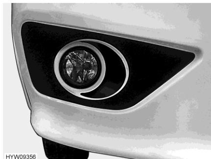
Fig. 163 Feu(x) de virages/projecteur antibrouillard
