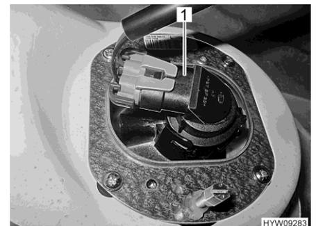
Fig. 164 Feu(x) de virages/projecteur antibrouillard (vue de l'arrière)
