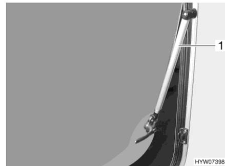
Fig. 45 Fenêtre projetante avec bras automatique
