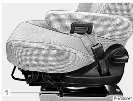
Fig. 58 Levier (pour faire tourner le siège) (Aguti GIS-Liner)
