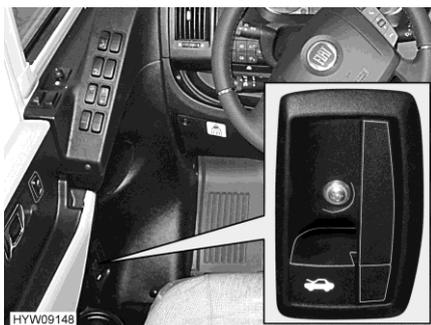
Fig. 23 Levier de déverrouillage (capot moteur)
