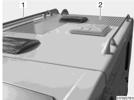
Fig. 3 Galerie de toit et tôle de marche
