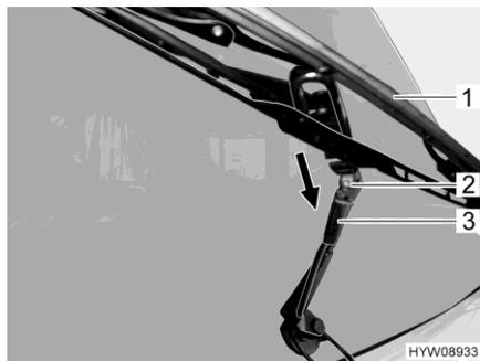
Fig. 157 Remplacer un balai d'essuie-glace
