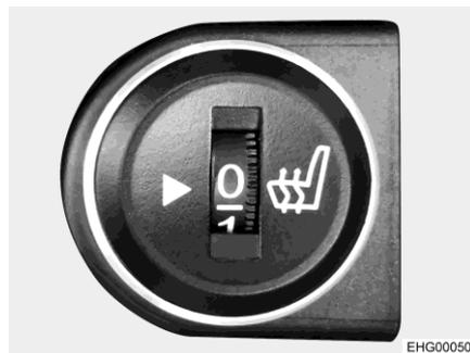
Fig. 18 Interruttore per riscaldamento del sedile
