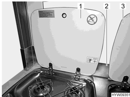
Fig. 125 Lastra proteggifiamma (area cottura)
