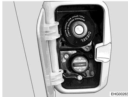
Fig. 26 Bocchettone di riempimento
