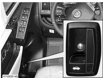
Fig. 23 Leva di sbloccaggio (cofano motore)
