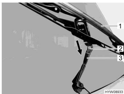
Fig. 157 Sostituzione della spazzola del tergicristallo
