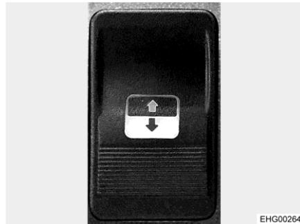
Fig. 19 Interruttore (alzacristalli elettrico nella porta conducente)
