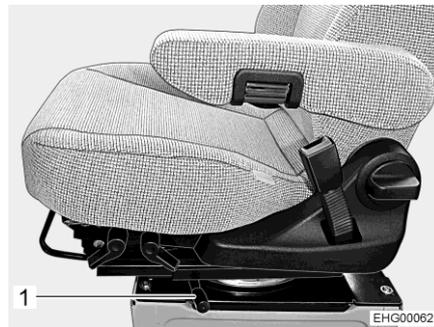
Fig. 58 Leva (rotazione del sedile)
