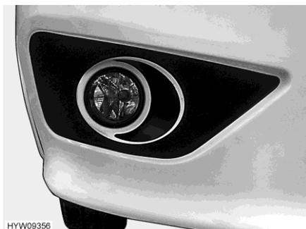
Fig. 163 Luce con regolazione in curva/luce fendinebbia
