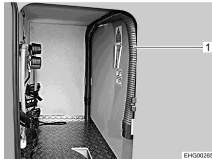
Fig. 142 Tubo di gomma per lo scarico (vano portabombole)
