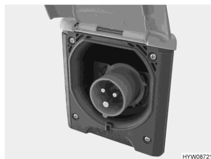
Fig. 107 Collegamento a 230 V al veicolo (presa CEE)
