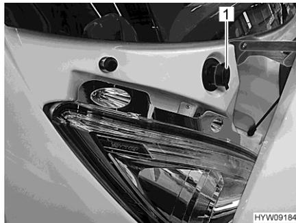
Fig. 25 Bocchettone di riempimento (contenitore dell'acqua di lavaggio)
