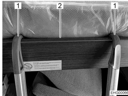
Fig. 72 Scaletta di accesso (letto basculante)
