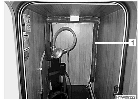
Fig. 143 Tubo di gomma per lo scarico (base estraibile del vano portabombole)
