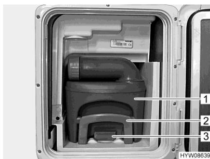
Fig. 149 Serbatoio fecale (nel veicolo)
