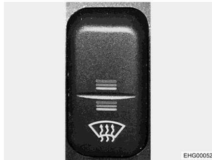
Fig. 11 Interruttore a bilico (riscaldamento del parabrezza)
