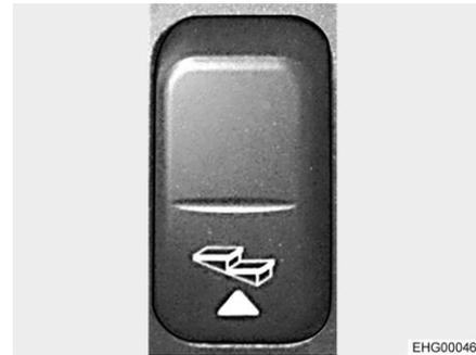
Fig. 10 Interruttore a bilico dello scalino di ingresso (cruscotto)
