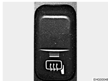
Fig. 21 Interruttore (riscaldamento degli specchietti)
