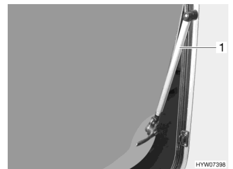
Bilde 45 Vindu som kan åpnes utover med armer med automatisk låsing
