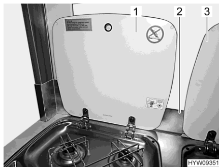
Bilde 125 Flammevernplate (kokeplassen)
