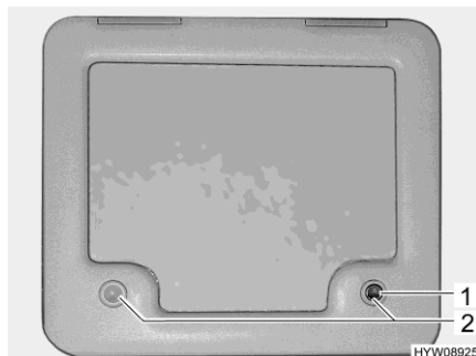
Bilde 148 Klaff (kloakktank)
