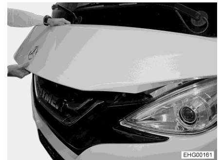
Fig. 36 Presa corretta per l'apertura del cofano del motore
