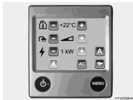
Fig. 176 Menu delle impostazioni (centralina di controllo)
