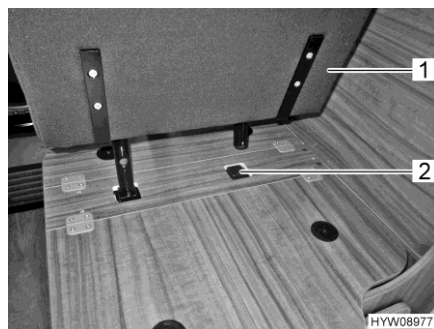
Fig. 24 Inserire il sedile installabile nel supporto
