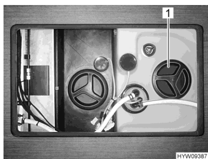
Fig. 225 Apertura per la pulizia (serbatoio dell'acqua)
