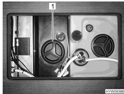
Fig. 226 Apertura per la pulizia (serbatoio delle acque grigie)
