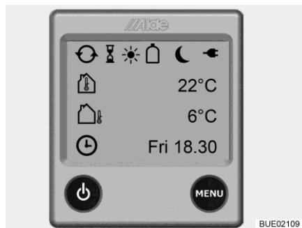
Fig. 175 Schermata iniziale (centralina di controllo)
