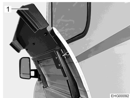
Afb. 132 Gaskast (serviceluik geopend)
