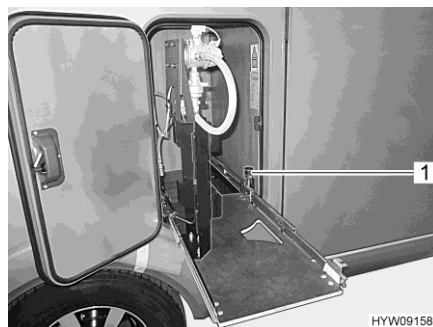
Kuva 131 Kaasupullokotelon alusta vaihtoasennossa
