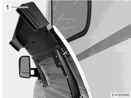
Kuva 132 Kaasupullokotelo (Ulkoluukku, auki)
