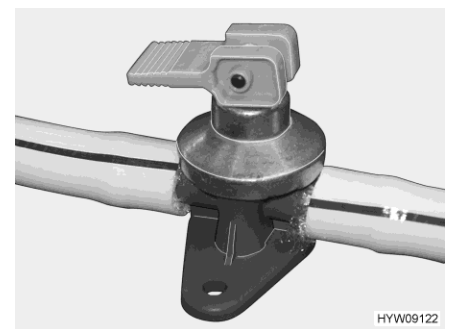
Kuva 173 Vedenpoistohana (kuumavesiboileri Alde)
