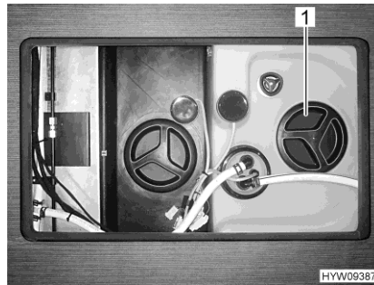
Kuva 220 Puhdistusaukko (vesisäiliö)
