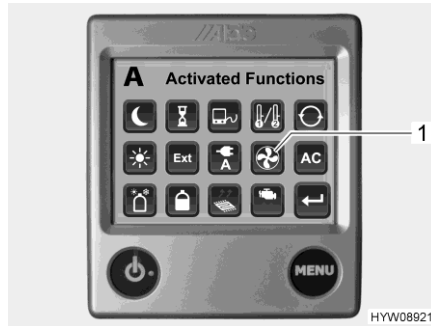
Kuva 178 Aktivoidut toiminnot (lisäpuhallin)
