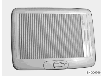
Kuva 74 Kattoluukku (lamelliverho suljettuna)
