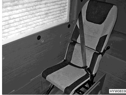
Kuva 31 Lisäistuimen taittaminen auki 3
