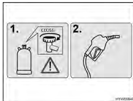
Fig. 10 Warning notice (fuel filler neck)
