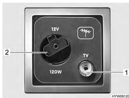
Bilde 49 Stikkontakter (ekstern satellittantenne)
