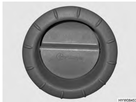
Bilde 73 Luftdyse (varmlufts-varmeanlegget)
