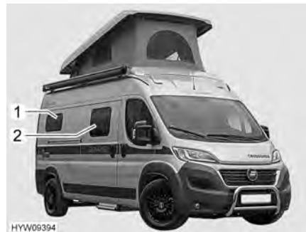
Bilde 15 Vindu med åpning utover (høyre side)
