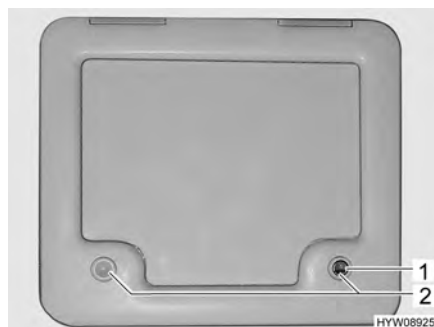
Bilde 110 Klaff (kloakktank)
