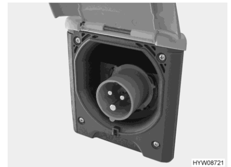
Fig. 153 Raccordement 230 V sur le véhicule (prise de courant CEE)
