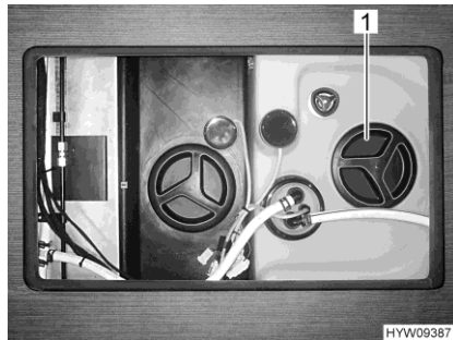
Fig. 225 Ouverture de nettoyage (réservoir d'eau)
