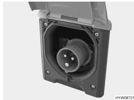
Kuva 147 230 V:n liitäntä ajoneuvolla (CEE-pistorasia)
