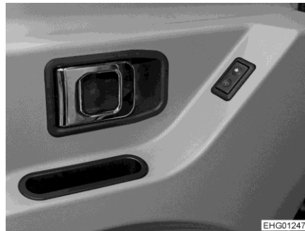
Kuva 34 Vipukytkin (kuljettajan oves- sa oleva sähköinen ikkunannos- tin)
