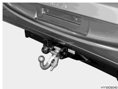
Kuva 8 Perävaunun vetokoukku (irrotettava)
