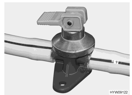
Kuva 201 Vedenpoistohana (kuumavesiboileri Alde)
