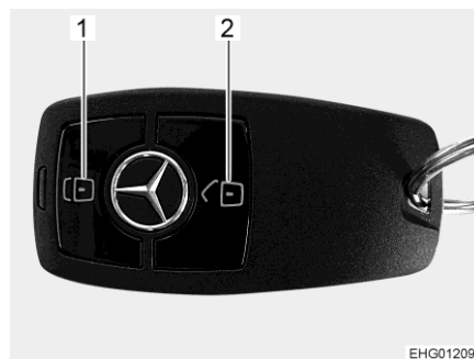
Afb. 50 Afstandsbediening (centrale vergrendeling)
