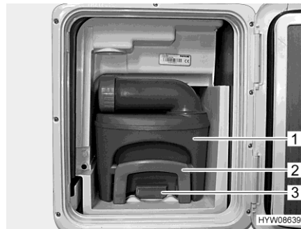
Afb. 214 Fecaliëncassette (in het voertuig)
