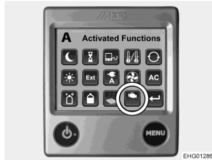
Afb. 180 Functie Motorverwarming (extra ventilator)
