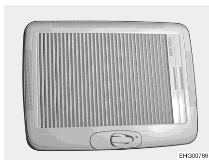
Afb. 79 Dakluik (lamelgordijn gesloten)
