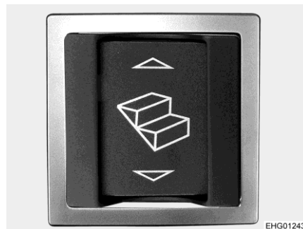
Afb. 7 Wipknop voor opstap (ingangsbereik)
