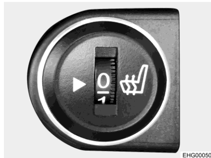
Afb. 20 Schakelaar voor stoelverwarming
