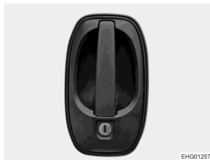
Afb. 53 Deurslot (bestuurdersdeur/ woonruimtedeur buiten)
