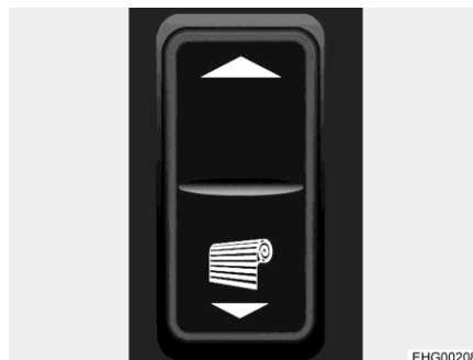
Afb. 71 Wipknop (verduisterings- rollo/zonnescher)
