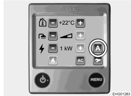
Afb. 177 Instelmenu (extra ventilator)
