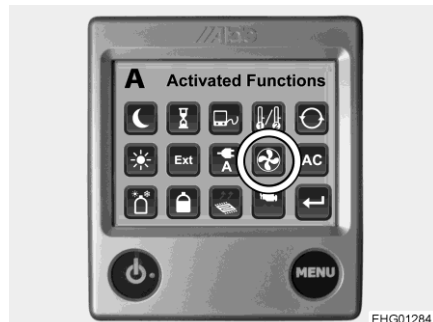
Afb. 178 Boosterfunctie (extra ventilator)
