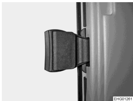
Afb. 60 Greep om het passagiersraam te openen
