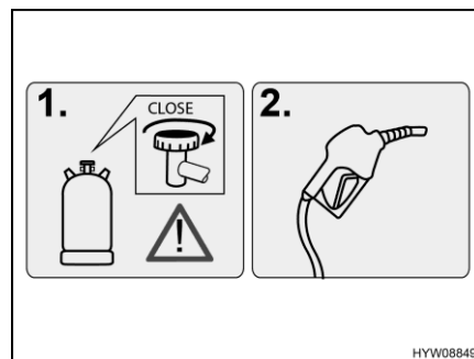
Kuva 14 Varoitus (polttoaineen täyttöaukko)
