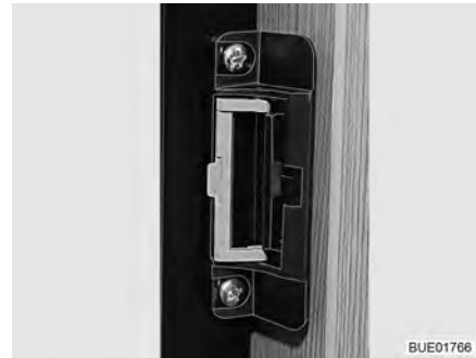
Fig. 93 Dispositivo di chiusura (posizione di ricircolo d'aria)
