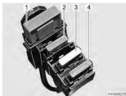
Fig. 69 Fusibili (batteria dell'abitacolo)
