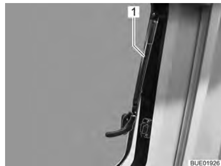
Fig. 17 Finestra apribile con deflettore automatico
