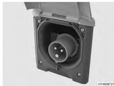
Fig. 67 Collegamento a 230 V al veicolo (presa CEE)
