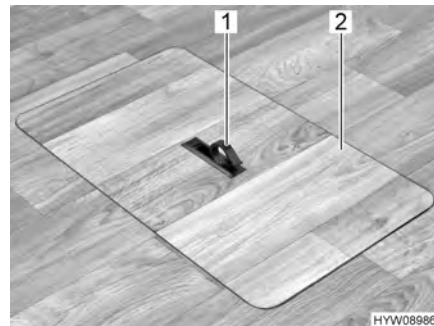
Fig. 43 Copertura vano pavimento (maniglia estratta)
