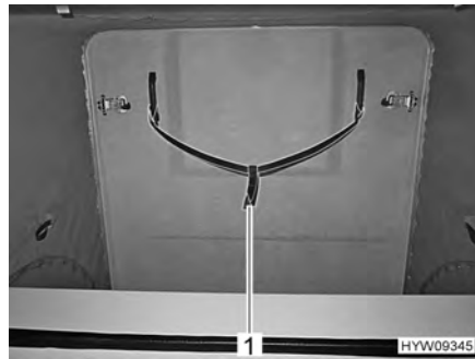
Fig. 37 Cinghia di servizio (tetto a soffietto)
