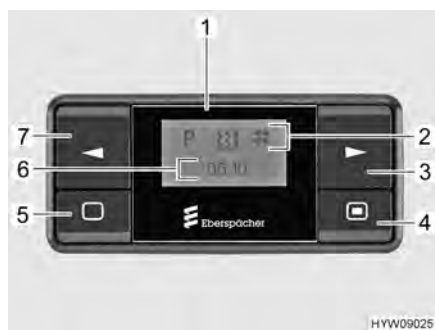
Fig. 80 Centralina di controllo (riscaldamento ad aria calda)
