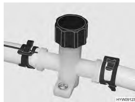
Fig. 98 Rubinetto di scarico (tubatura dell'acqua)
