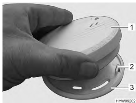
Fig. 119 Montaggio del rivelatore di fumo
