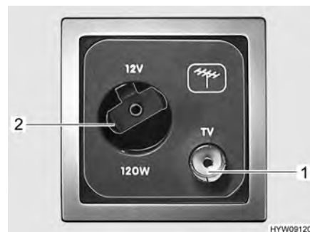
Fig. 49 Prese (antenna satellitare esterna)
