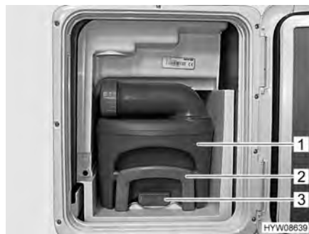
Fig. 112 Serbatoio fecale (nel veicolo)
