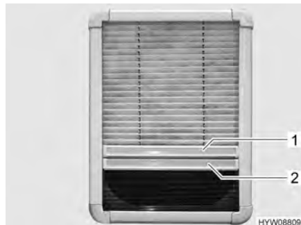
Fig. 19 Tendina oscurante pieghevole e protezione contro gli insetti
