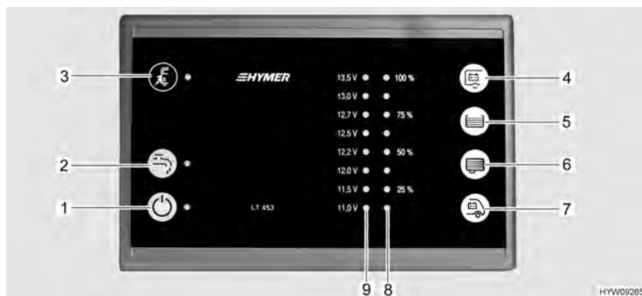
Fig. 65 Pannello di controllo (LT 453)
