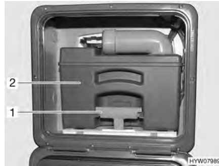
Fig. 114 Serbatoio fecale (nel veicolo) (alternativa)
