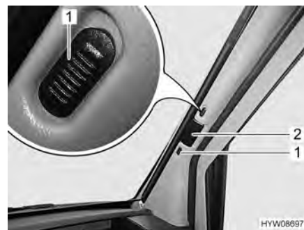
Fig. 21 Tendina oscurante pieghevole (parabrezza, Mercedes-Benz)
