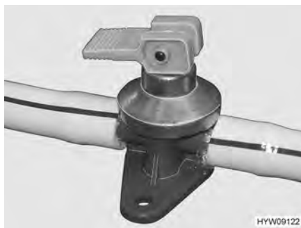
Fig. 86 Rubinetto di scarico (boiler Truma)
