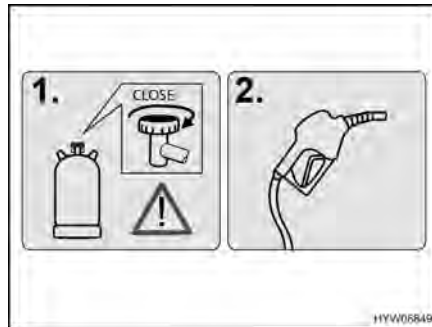
Fig. 10 Avviso (bocchettone di riempimento per il rifornimento di carburante)
