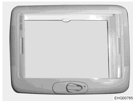
Obr. 72 Střešní poklop (zavřený)
