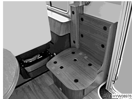
Obr. 26 Úložný prostor pod lavicí
