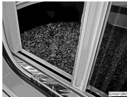
Obr. 59 Ochrana proti hmyzu (dolní vedení)
