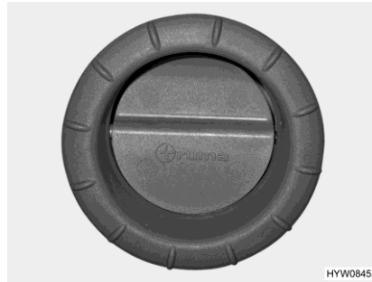
Obr. 157 Vzduchová výstupní tryska (teplovzdušné topení)
