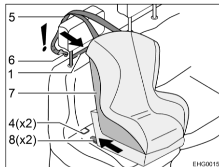
Obr. 21 Upevnění se systémem Isofix
