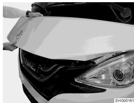
Obr. 39 Správná poloha rukojeti pro otevření kapoty motoru
