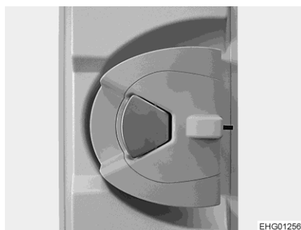
Obr. 54 Dveřní zámek (dveře obytného prostoru, vnitřní)
