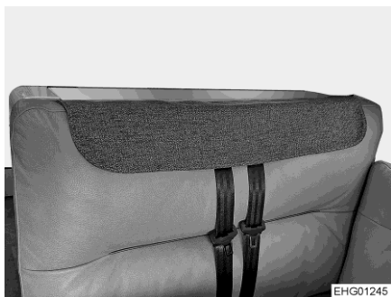
Bilde 86 Sikkerhetsbeltepanelet montert
