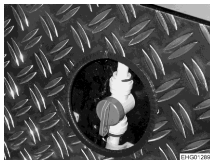
Bilde 183 Tilløpsventil (oppvarming bakre lasteluke)
