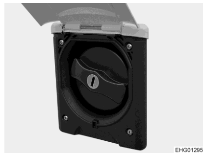
Bilde 202 Deksel (drikkevann-påfyllingsstuss)
