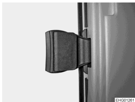
Bilde 62 Håndtak for å åpne passasjervinduet
