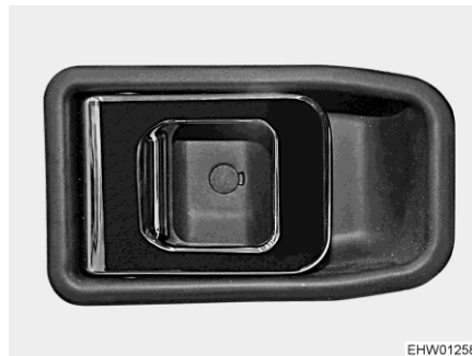
Bilde 56 Dørlås (førerdør innvendig)
