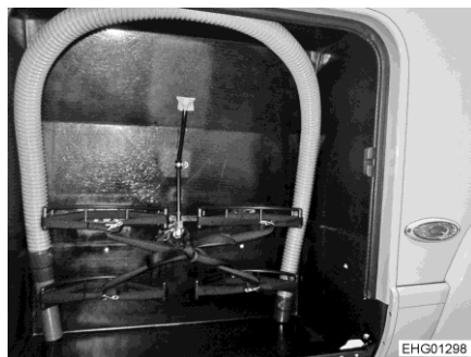
Bilde 206 Spillvannsslange (gasskap)
