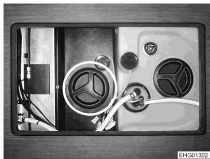
Bilde 220 Rengjøringsåpning (spillvannstank)
