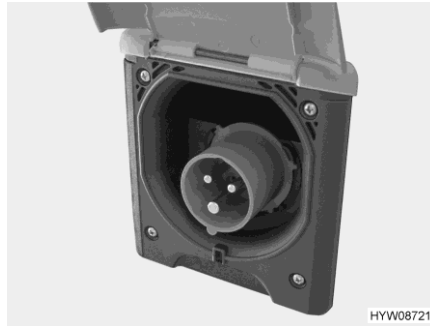
Bilde 147 230 V-tilkobling til kjøretøyet (CEE-stikkontakt)
