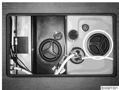
Bilde 219 Rengjøringsåpning (vanntank)
