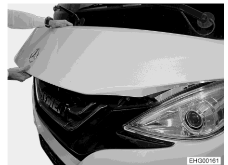
Bilde 39 Riktig håndtaksposisjon for åpning av motorlokket
