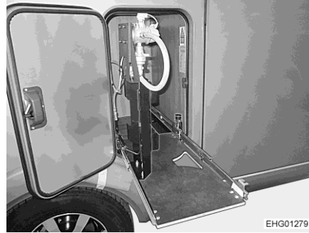
Bilde 130 Gasskaputtrekk i posisjon for utskifting
