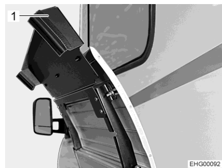
Bilde 131 Gasskap (uvendig luke åpent)
