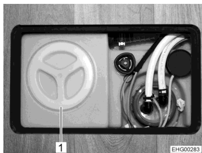
Fig. 116 Apertura per la pulizia (serbatoio dell'acqua)
