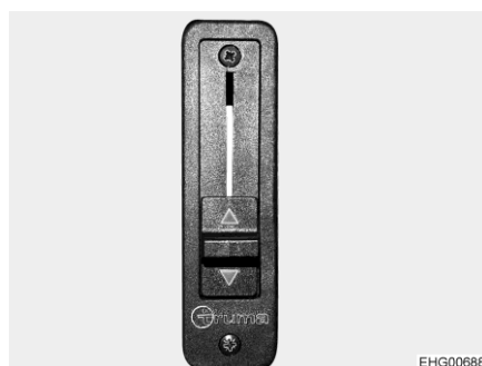
Fig. 115 Regolatore a scorrimento per distribuzione dell'aria calda nel tetto con posto letto
