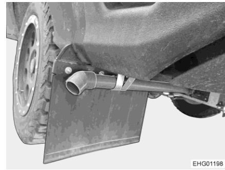
Fig. 128 Tubo di scarico
