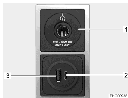
Fig. 90 Presa multipla per luci e USB
