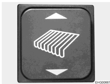
Fig. 19 Interruttore a bilico tenda (zona di ingresso)
