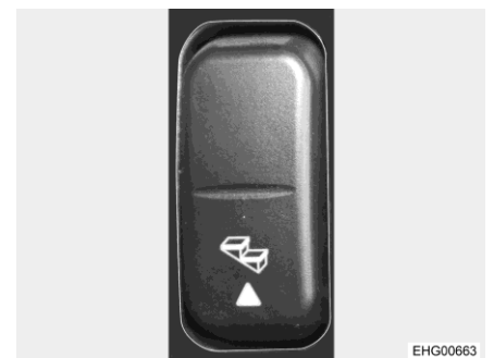
Fig. 5 Interruttore a bilico per scalino di ingresso (cruscotto)
