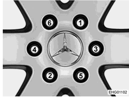
Afb. 118 Wielmoeren of wielschroeven kruisgewijs vastdraaien
