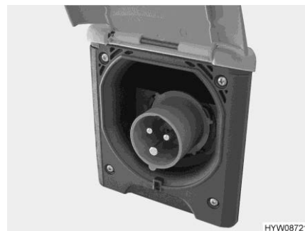
Afb. 135 230 V-anlutning på fordonet (CEE-uttag)
