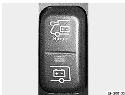
Afb. 124 Omkopplare för strömförsörjning radio
