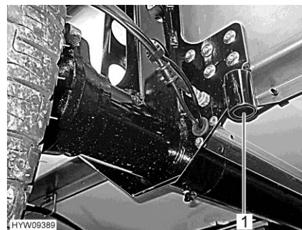
Afb. 230 Fästpunkt för domkraft (bakaxel)
