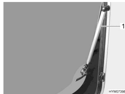
Afb. 58 Överkantshängt fönster med automatik-spärr
