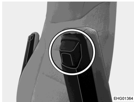
Bild 24 Verriegelung Armlehne (Variante Aguti)
