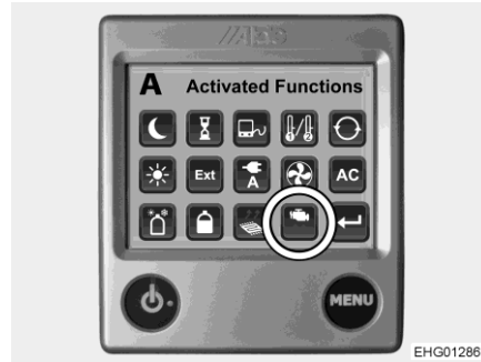
Bild 125 Funktion Motorheizung (Zusatzgebläse)
