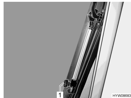
Afb. 61 Draaibare uitzetter (dakluikraam)
