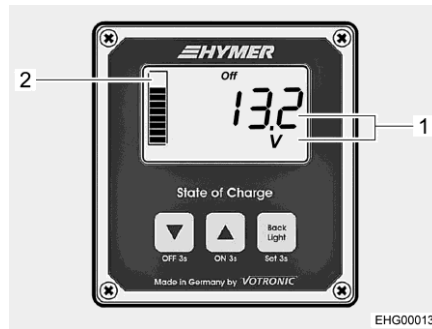
Afb. 128 Display (aanduiding accuspanning)
