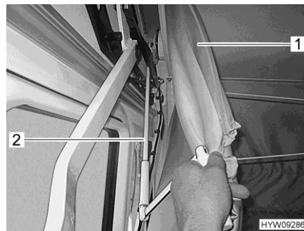
Afb. 68 Handslinger voor noodbedrijf
