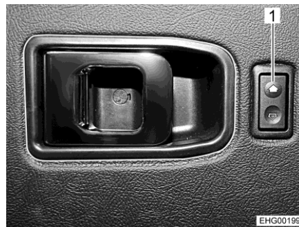
Afb. 29 Schakelaar (elektrische raamschakelaar in de bestuurdersdeur)
