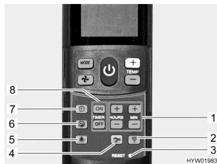
Afb. 175 Afstandsbediening met insteltoetsen (klimaatregeling)
