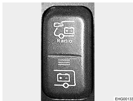
Afb. 124 Keuzeschakelaar voor stroomvoorziening radio
