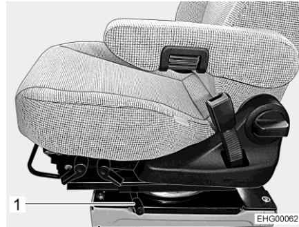
Afb. 77 Hendel (draaien van de stoel)
