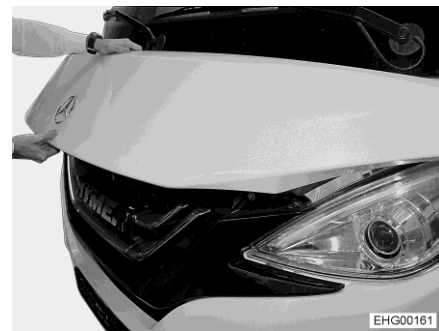
Afb. 34 Correcte handgreep voor het openen van de motorkap
