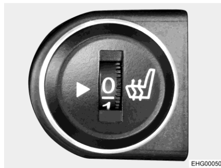
Afb. 15 Schakelaar voor stoelverwarming
