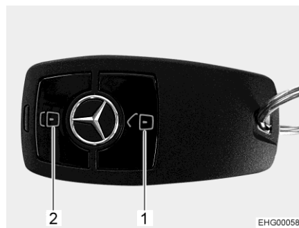
Afb. 46 Afstandsbediening (centrale vergrendeling)
