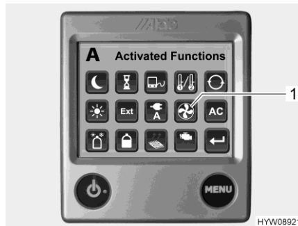
Afb. 183 Ingeschakelde functies (extra ventilator)
