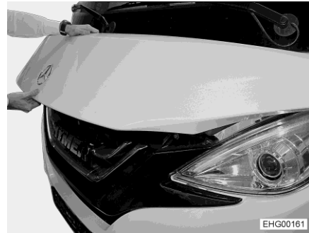
Afb. 36 Correcte handgreep voor het openen van de motorkap
