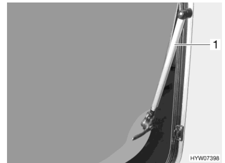
Afb. 62 Uitzetbaar raam met automatische uitzetters
