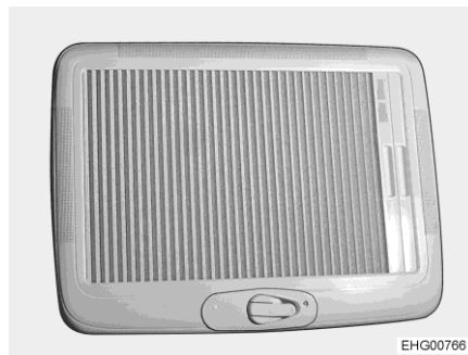
Kuva 79 Kattoluukku (lamelliverho suljettuna)
