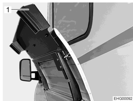
Kuva 134 Kaasupullokotelo (Ulkoluukku, auki)
