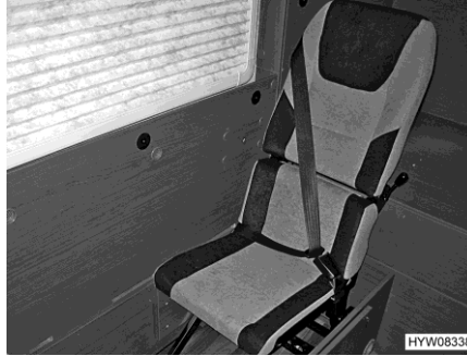
Kuva 30 Lisäistuimen taittaminen auki 3
