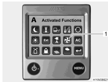
Kuva 183 Aktivoidut toiminnot (lisäpuhallin)
