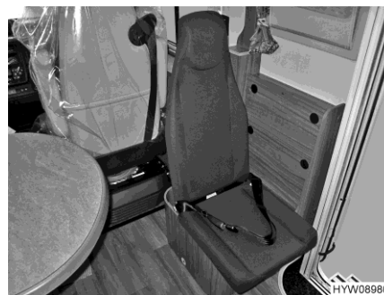
Obr. 27 Zástrčné sedadlo (vykloněné nahoru)
