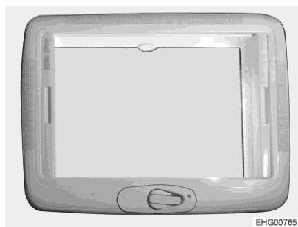
Obr. 77 Střešní poklop (zavřený)
