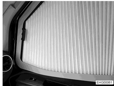
Obr. 69 Skládací zatemnění (okno spolujezdce)
