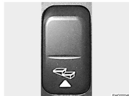
Obr. 8 Kolébkový spínač pro vstupní schody (spínací lišta)
