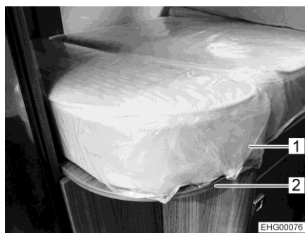
Obr. 124 Prodloužení ložné plochy s přidavným čalouněním
