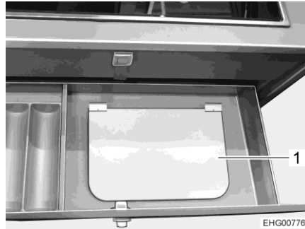
Fig. 57 Extensión del mostrador (posición de estacionamiento)
