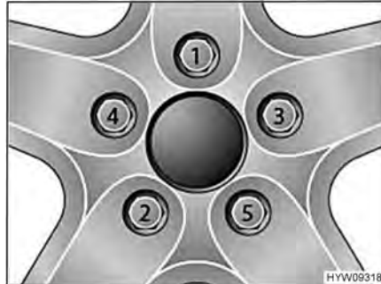
Afb. 122 Wielmoeren of wielschroeven kruisgewijs vastdraaien
