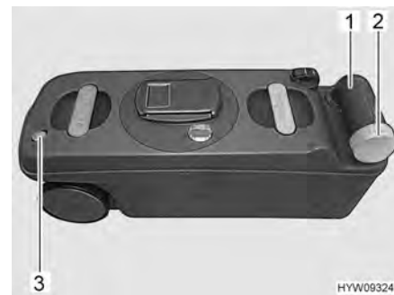
Fig. 113 Réservoir pour matières fécales
