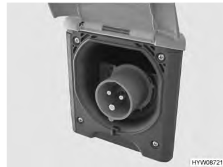
Fig. 67 Raccordement 230 V sur le véhicule (prise de courant CEE)
