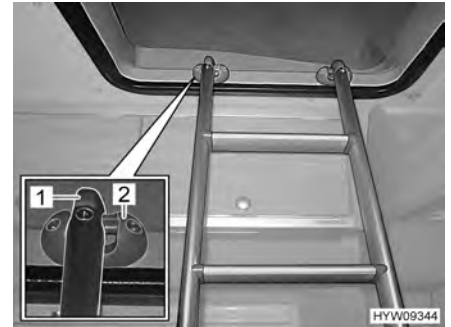
Fig. 34 Échelle de montée (accrochée)
