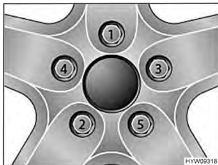
Fig. 122 Serrer en croix les écrous ou les boulons de roue
