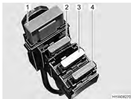
Fig. 69 Fusibles (batterie de cellule)
