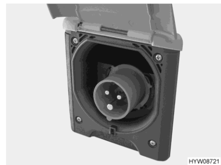
Bilde 107 230 V-tilkobling til kjøretøyet (CEE-stikkontakt)
