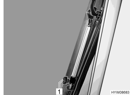
Bilde 42 Dreiearm (taklukevindu)
