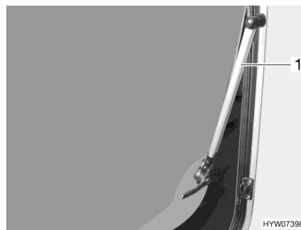
Bilde 39 Vindu som kan åpnes utover med armer med automatisk låsing
