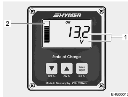
Fig. 100 Panel de visualización (visualización de la tensión de batería)
