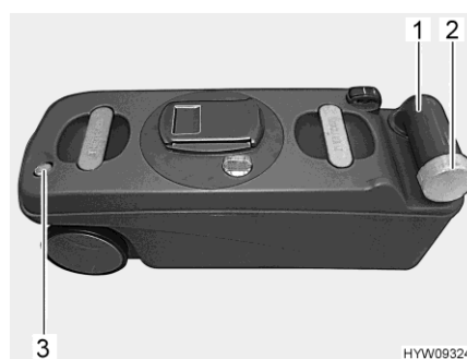
Fig. 171 Depósito de aguas fecales (ejemplo)
