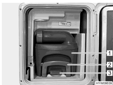
Fig. 170 Depósito de aguas fecales (en el vehículo)
