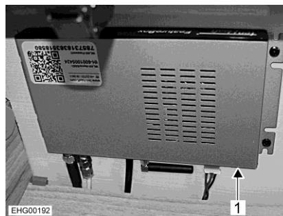
Fig. 113 Unidad de control (instalación de antena parabólica de TV, ten Haaft)
