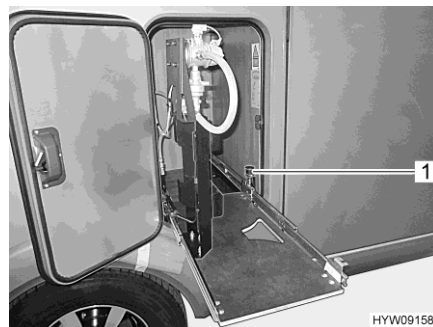
Fig. 91 Dispositivo de extracción de caja para bombonas de gas en posición de cambio
