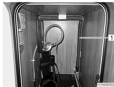
Fig. 160 Manguera de aguas residuales (dispositivo de extracción de caja para bombonas de gas)
