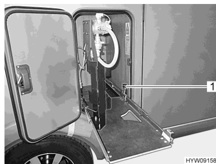
Fig. 91 Extension du compartiment à gaz en position de changement de bouteille
