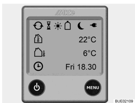
Fig. 123 Écran de démarrage (unité de commande)
