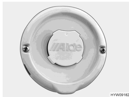
Fig. 131 Cheminée murale (chauffage à eau chaude)
