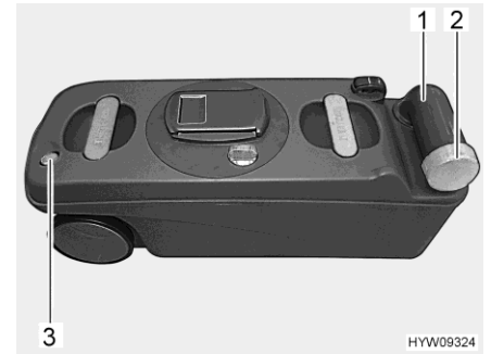
Fig. 171 Réservoir pour matières fécales (exemple)
