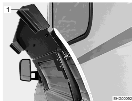
Kuva 134 Kaasupullokotelo (Ulkoluukku, auki)
