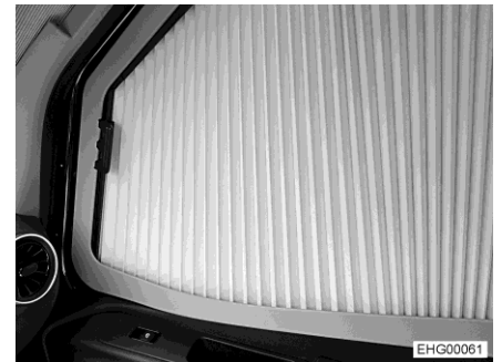
Kuva 69 Taitekaihdin (apuohjaajan ikkuna)
