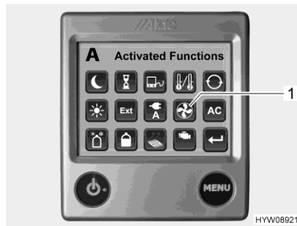
Kuva 183 Aktivoidut toiminnot (lisäpuhallin)
