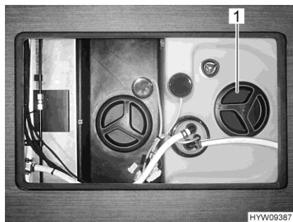
Fig. 225 Orificio de limpieza (depósito de agua)
