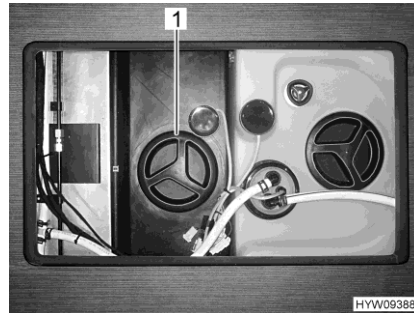
Fig. 226 Orificio de limpieza (depósito de aguas residuales)
