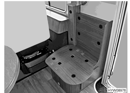
Fig. 23 Espacio de almacenamiento debajo del banco
