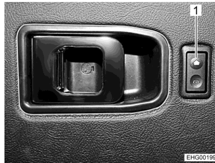
Fig. 31 Interruptor (elevelunas eléctrico en la puerta del conductor)
