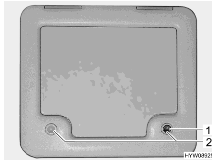
Fig. 219 Trampilla (depósito de aguas fecales)
