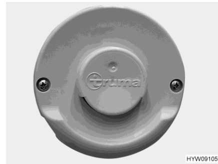
Fig. 190 Tubo de chimenea en la pared (calefacción de aire caliente)
