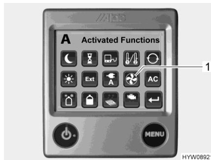
Fig. 183 Funciones activadas (ventilador adicional)
