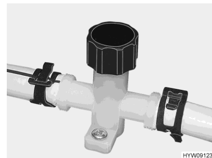
Fig. 172 Llave de desagüe (tubería de agua)
