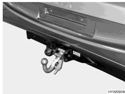
Bild 6 Anhängerkupplung (abnehmbar)
