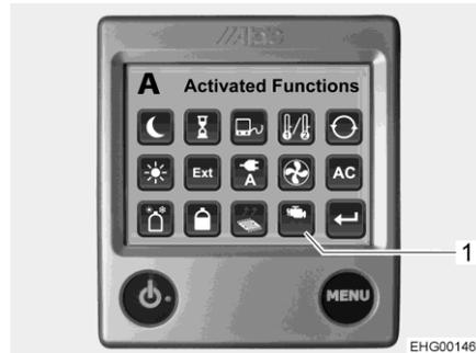
Bild 185 Schaltfläche Motorheizung
