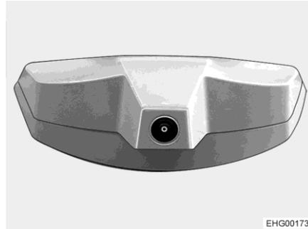
Bild 34 Rückfahrkamera
