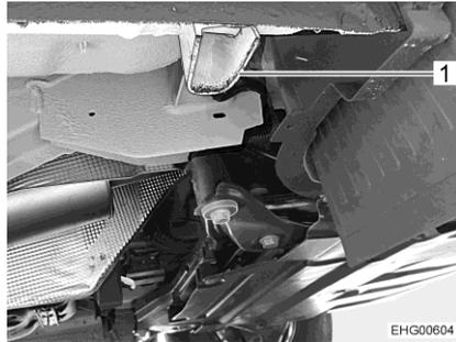
Bild 245 Aufnahme Vorderachse
