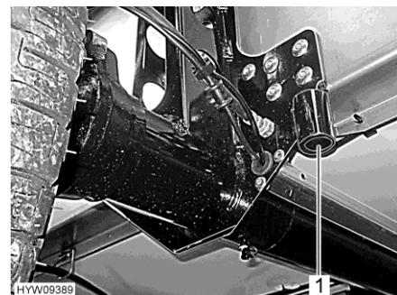
Bild 247 Aufnahme Hinterachse
