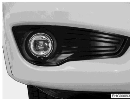
Bild 237 Kurvenlicht/Nebelscheinwerfer
