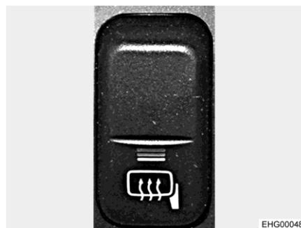
Bild 33 Schalter (Spiegelheizung)
