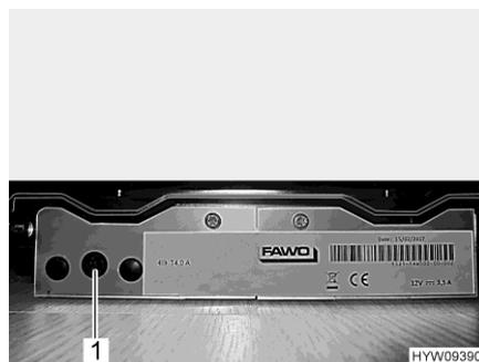
1 Glasrohrsicherung 4,0 A
