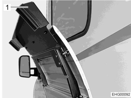
Bild 134 Gaskasten (Außenklappe geöffnet)
