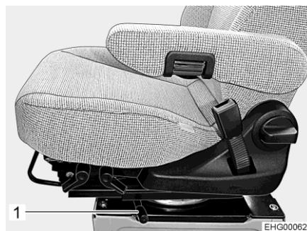
Bild 87 Hebel (Drehen des Sitzes)
