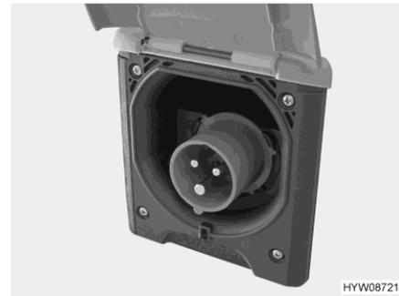
Bild 153 230-V-Anschluss am Fahrzeug (CEE-Steckdose)
