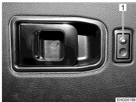
Bild 31 Schalter (elektrischer Fensterheber in der Fahrertür)
