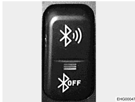
Bild 139 Wipptaster (Bluetooth-Anschluss)
