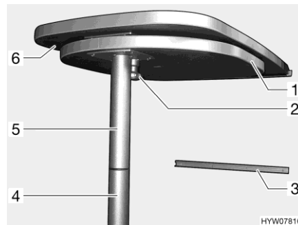
Fig. 98 Tavolo sospeso con piede di sostegno scomponibile
