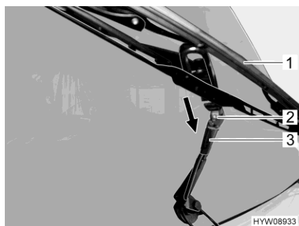
Fig. 231 Sostituzione della spazzola del tergicristallo
