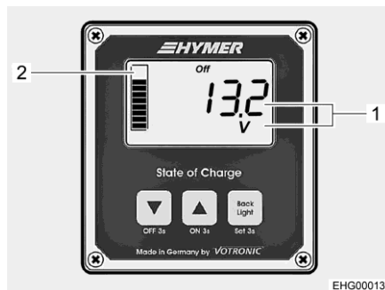
Fig. 143 Pannello indicatore (indicatore della tensione della batteria)
