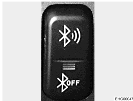
Fig. 139 Pulsante basculante (collegamento Bluetooth)
