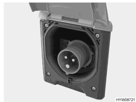
Fig. 153 Collegamento a 230 V al veicolo (presa CEE)
