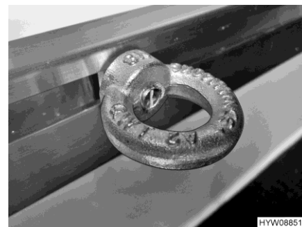
Fig. 5 Occhiello di ancoraggio (serrato)
