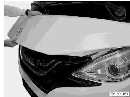
Obr. 36 Správná poloha rukojeti pro otevření kapoty motoru
