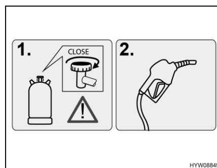
Obr. 39 Výstražné upozornění (plnicí hrdlo palivové nádrže)
