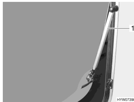
Obr. 62 Vyklápěcí okno s automatickým vyklápěcím mechanismem
