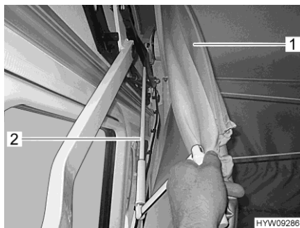
Obr. 75 Ruční klika pro nouzový provoz
