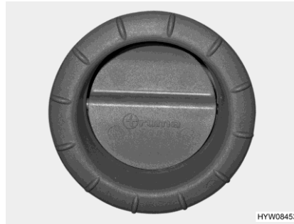
Obr. 167 Vzduchová výstupní tryska (teplovzdušné topení)
