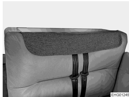
Kuva 92 Turvavyön päällinen kiinnitetty
