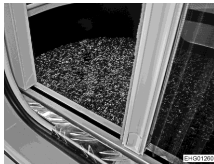
Kuva 57 Hyönteissuoja (alempi ohjaamo)
