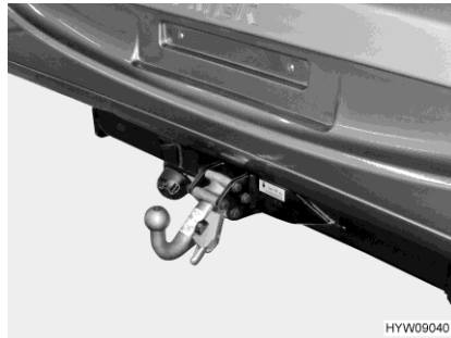
Kuva 6 Perävaunun vetokoukku (irrotettava)
