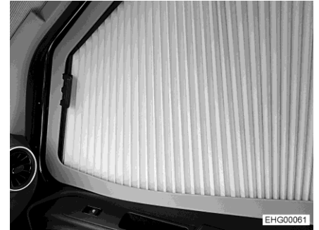
Kuva 69 Taitekaihdin (apuohjaajan ikkuna)
