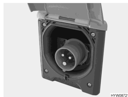
Fig. 71 Raccordement 230 V sur le véhicule (prise de courant CEE)
