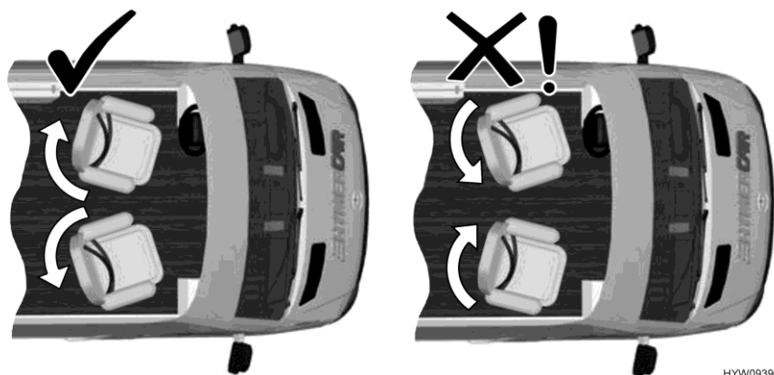
Fig. 44 Tenir compte du sens de rotation des sièges conducteur et passager
