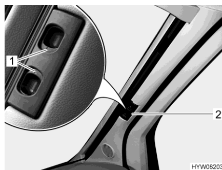
Fig. 23 Dispositif occultant plissé (pare-brise)
