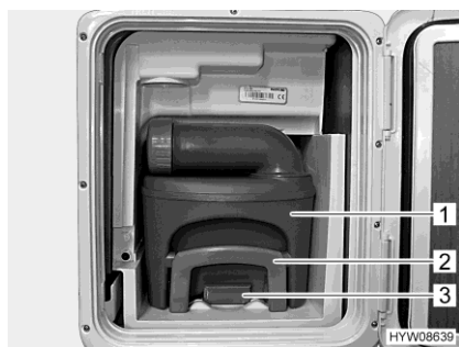
Fig. 113 Réservoir pour matières fécales (dans le véhicule)
