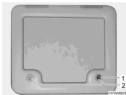
Fig. 112 Portillon (réservoir pour matières fécales)
