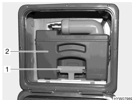
Fig. 115 Réservoir pour matières fécales (dans le véhicule) (alternative)
