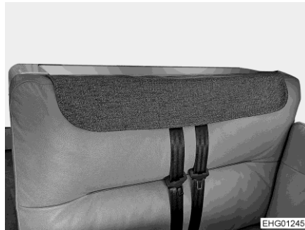
Fig. 17 Cubierta para cinturones de seguridad instalada
