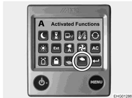
Fig. 125 Función Calefacción del motor (ventilador adicional)
