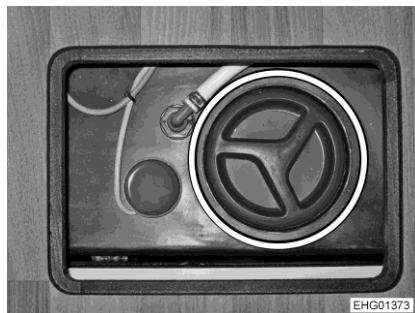
Fig. 162 Orificio de limpieza (depósito de aguas residuales)
