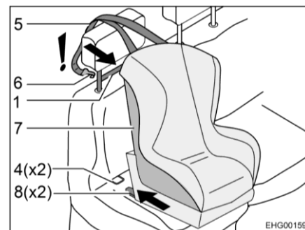
Fig. 21 Fijación con Isofix
