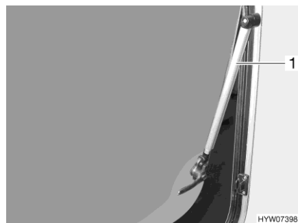
Fig. 42 Ventana abatible con soporte automático
