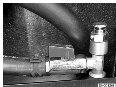
Fig. 127 Grifo esférico (abierto)
