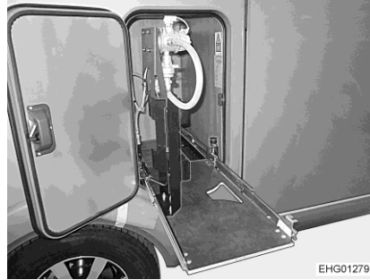
Fig. 93 Dispositivo de extracción de caja para bombonas de gas en posición de cambio
