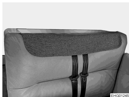
Fig. 64 Cubierta para cinturones de seguridad instalada
