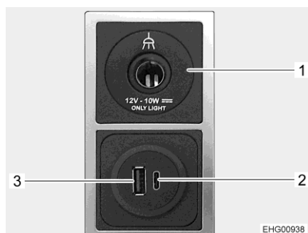
Bild 76 Kombinerat uttag för lampor och USB
