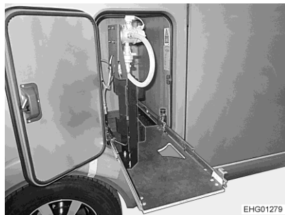
Bild 93 Utdragsdelen till gasboxen i bytesläge
