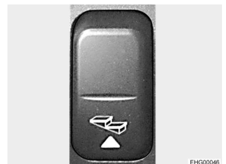
Bild 11 Vippknapp för fotsteg (reglagelist)
