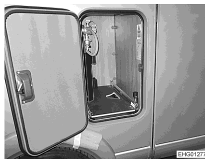
Bild 91 Utdragsdel till gasbox
