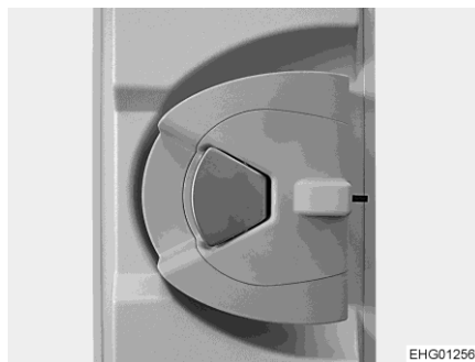
Bild 35 Dörrlås (bodelsdörr, insida)
