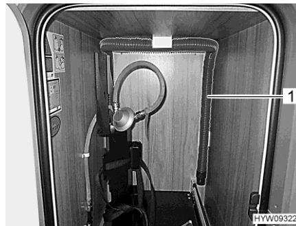
Bild 147 Avloppsslang (utdragsdel till gasbox)
