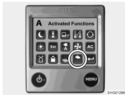
Bild 125 Funktion motorvärme (extra fläkt)
