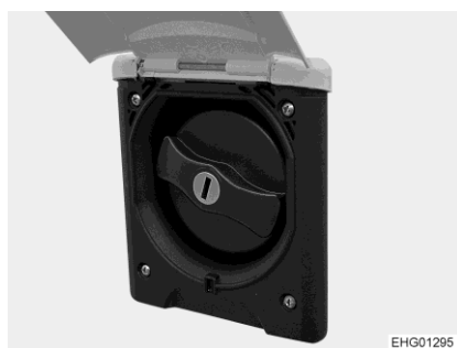
Bild 144 Lock (påfyllningsöppningen för dricksvatten)
