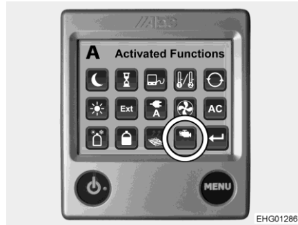
Bild 125 Funktion Motorheizung (Zusatzgebläse)
