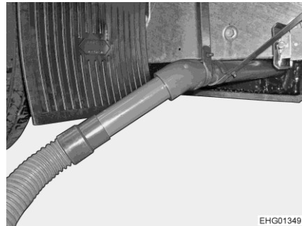
Bild 148 Ablaufrohr mit Abwasserschlauch
