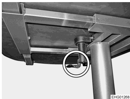
Bild 66 Hebel für Verschieben der Tischplatte
