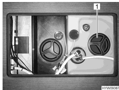
Fig. 217 Ouverture de nettoyage (réservoir d'eau)
