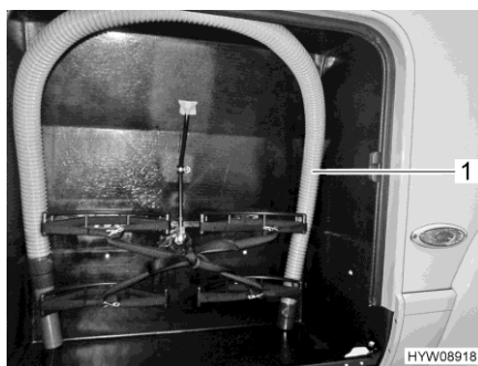
Fig. 206 Tuyau d'évacuation des eaux usées (compartiment à gaz)
