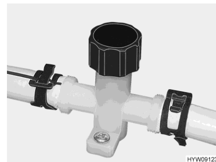
Fig. 164 Robinet de vidange (conduite d'eau)
