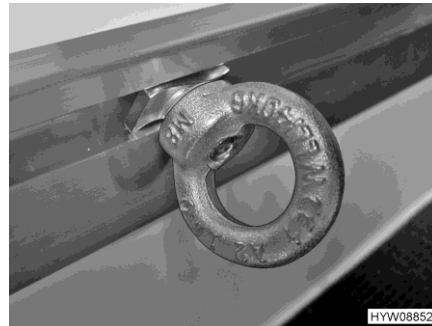
Fig. 2 Oëillet de serrage (déplaçable)
