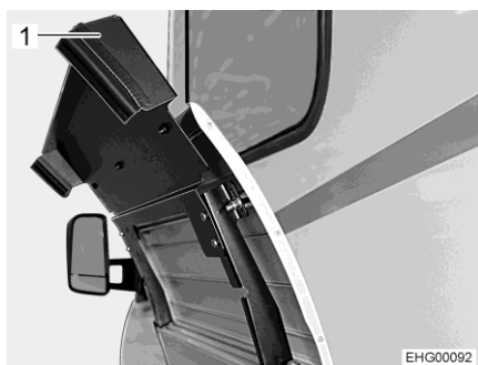
Fig. 124 Compartiment à gaz (portillon extérieur ouvert)
