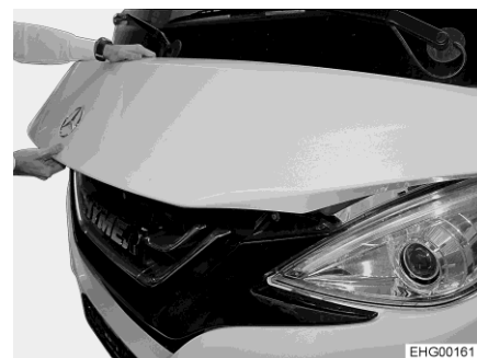
Fig. 34 Position correcte de la poignée pour ouvrir le capot moteur
