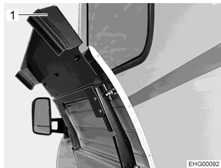
Bilde 120 Gasskap (uvendig luke åpent)
