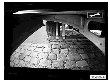
Bilde 34 Bilde fra kamera for spillvannstank (eksempel)
