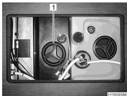
Bilde 210 Rengjøringsåpning (spillvannstank)
