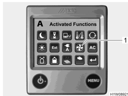
Afb. 167 Ingeschakelde functies (extra ventilator)
