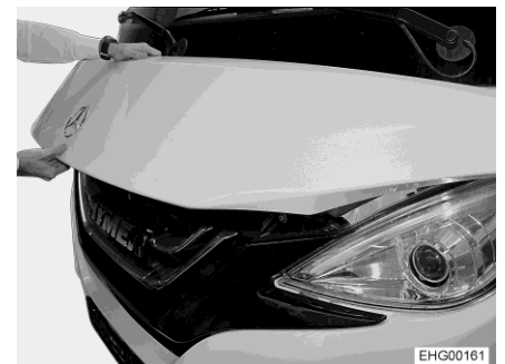
Fig. 36 Posición de agarre correcta para abrir el capó del motor
