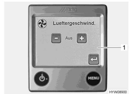
Fig. 184 Mando (ventilador adicional)
