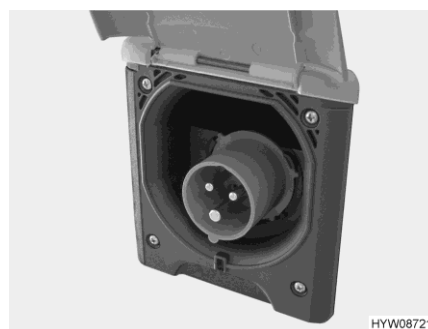
Fig. 153 Conexión de 230 V en el vehículo (caja de enchufe CEE)
