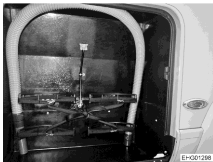
Rys. 206 Wąż odprowadzający ścieki (skrzynia na butle gazowe)
