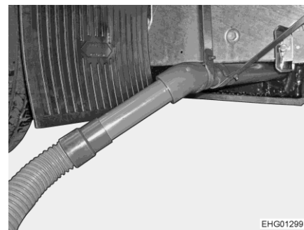
Rys. 207 Rura odpływowa z węzłem odprowadzającym ścieki
