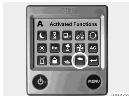
Rys. 180 Funkcja podgrzewania silnika (dodatkowa dmuchawa)
