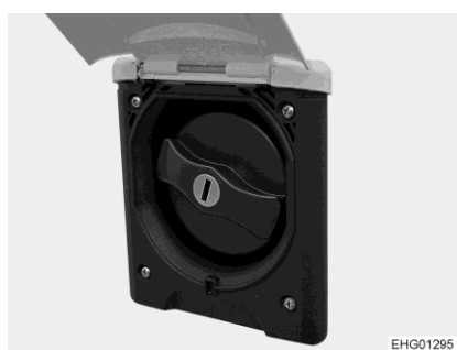
Rys. 202 Korek zamykający (króciec do napełniania wody pitnej)
