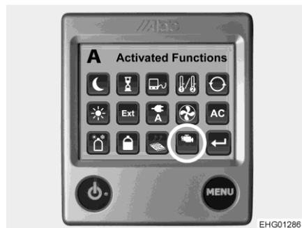
Fig. 180 Funzione riscaldamento a motore (ventola aggiuntiva)
