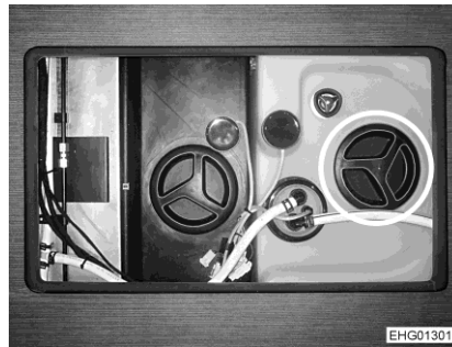
Fig. 219 Apertura per la pulizia (serbatoio dell'acqua)
