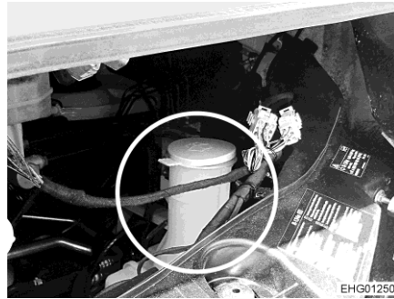
Fig. 40 Bocchettone di riempimento (contenitore dell'acqua di lavaggio)
