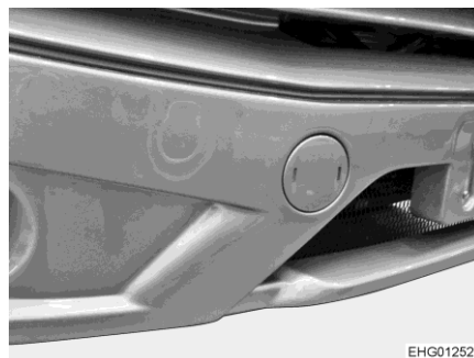
Fig. 43 Copertura (alloggiamento dell'occhione di traino)
