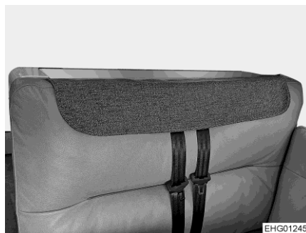
Fig. 16 Rivestimento delle cinture di sicurezza montato
