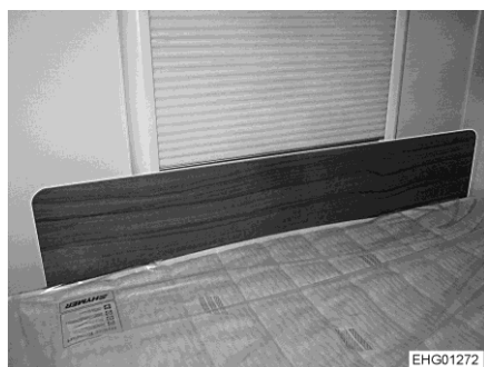
Fig. 111 Pannello di protezione/protezione anticaduta
