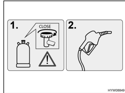
Fig. 42 Avviso (bocchettone di riempimento per il rifornimento di carburante)
