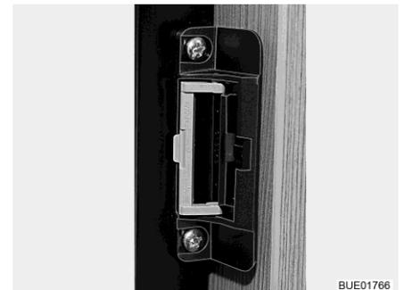
Fig. 197 Dispositivo de cierre (posición de ventilación)
