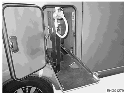
Fig. 130 Dispositivo de extracción de caja para bombonas de gas en posición de cambio
