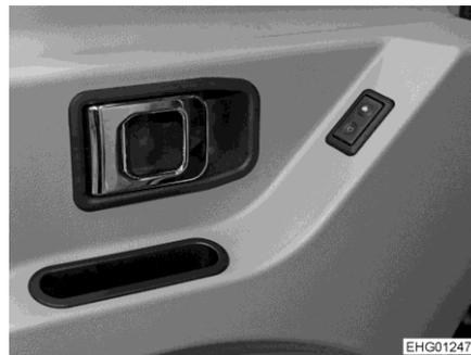
Fig. 34 Pulsador basculante (elevalunas eléctrico en la puerta del conductor)
