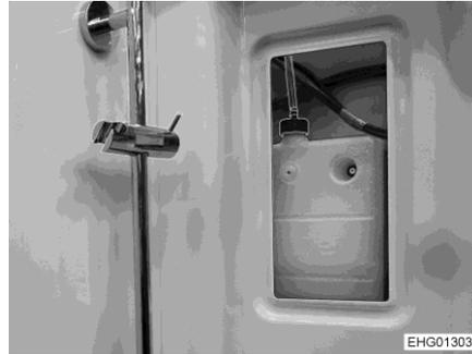
Fig. 222 Recipiente de compensación (calefacción de agua caliente)
