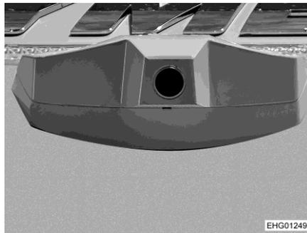
Fig. 37 Módulo de cámara
