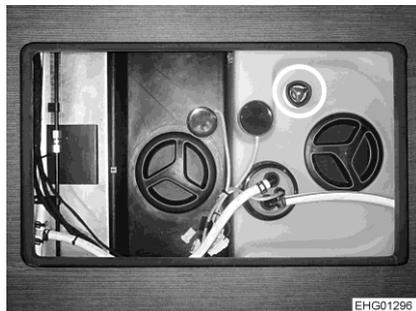
Fig. 203 Tirador giratorio (vaciado de agua)
