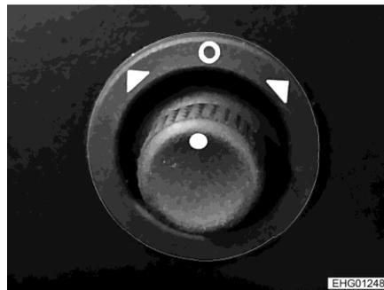
Fig. 35 Interruptor (retrovisores exteriores ajustables eléctricamente)
