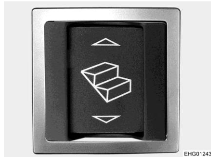
Fig. 9 Pulsador basculante para el escalón de entrada (zona de entrada)
