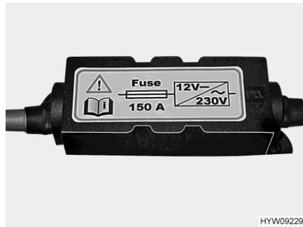
Fig. 152 Fusible (ondulador (150 A))
