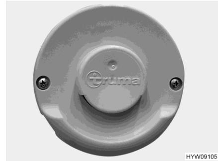
Fig. 185 Tubo de chimenea en la pared (calefacción de aire caliente)
