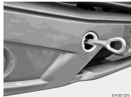
Fig. 44 Argolla de remolque (montada)
