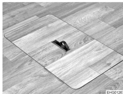
Fig. 83 Cubierta de servicio (tirador girado hacia fuera)
