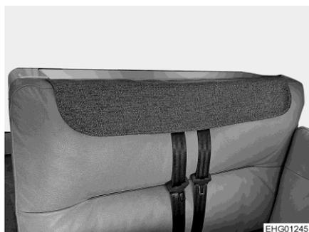
Fig. 86 Cubierta para cinturones de seguridad instalada
