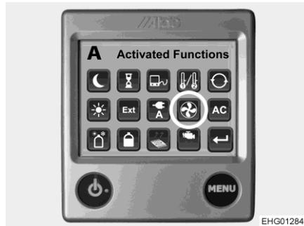
Fig. 178 Función de amplificador (ventilador adicional)
