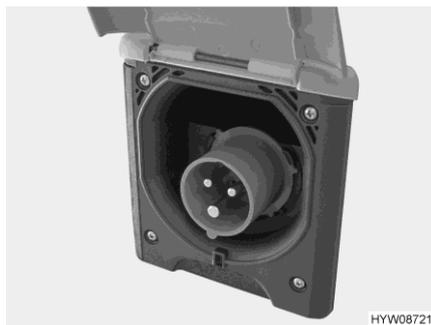
Fig. 147 Conexión de 230 V en el vehículo (caja de enchufe CEE)
