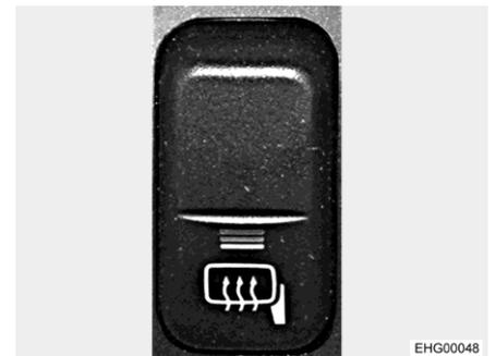
Fig. 36 Interruptor basculante (calefacción de los retrovisores)
