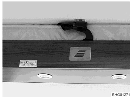
Fig. 100 Cinturón de retención
