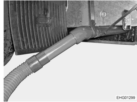
Fig. 207 Tubo de salida con manguera de aguas residuales
