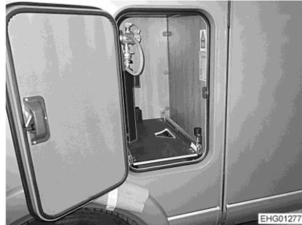
Fig. 128 Dispositivo de extracción de caja para bombonas de gas
