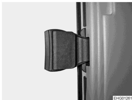
Fig. 62 Tirador para abrir la ventana del acompañante
