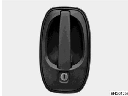
Fig. 55 Cerradura de la puerta (puerta del conductor en el exterior)
