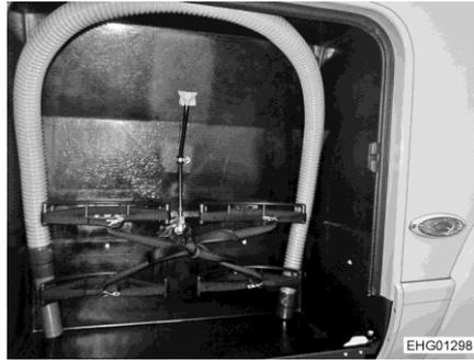
Fig. 206 Manguera de aguas residuales (caja para bombonas de gas)
