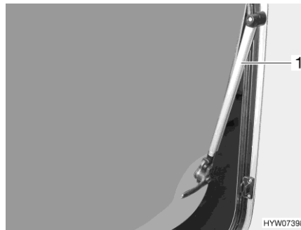
Afb. 64 Uitzetbaar raam met automatische uitzetters
