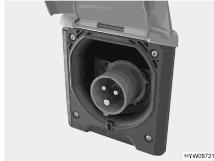
Afb. 147 230-V-aansluiting op het voertuig (CEE-contactdoos)
