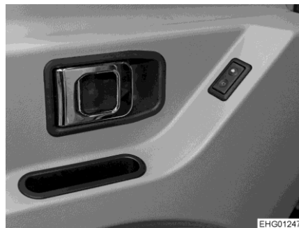
Afb. 34 Wipschakelaar (elektrische raamschakelaar in de bestuurdersdeur)
