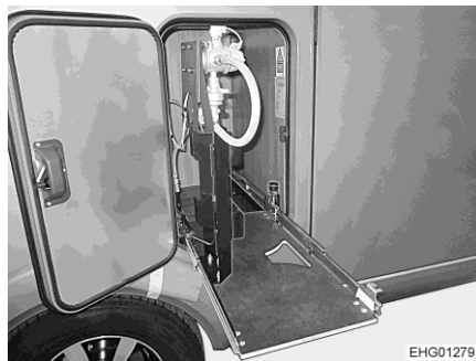
Afb. 130 Gaskast-uitschuifdeel in vervangingsstand
