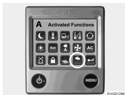
Afb. 180 Functie Motorverwarming (extra ventilator)
