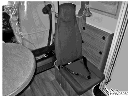
Bild 30 Stecksitz aufgeklappt
