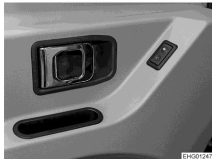
Bild 34 Wippschalter (elektrischer Fensterheber in der Fahrerhaustür)
