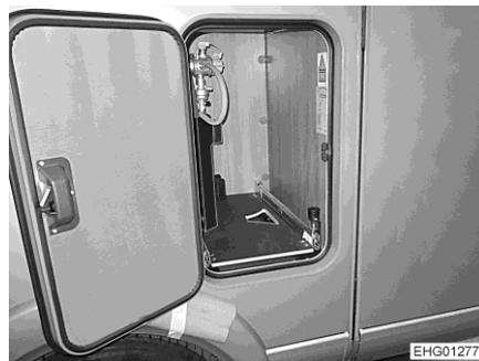
Bild 128 Gaskastenauszug
