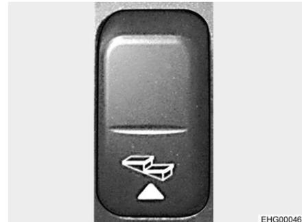
Bild 10 Wippschalter für Eintrittstufe (Schalterleiste)
