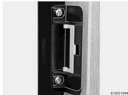
Bild 196 Verschlusseinrichtung (Normalstellung)
