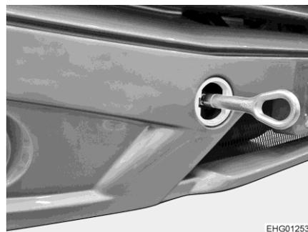
Bild 44 Abschleppöse (montiert)
