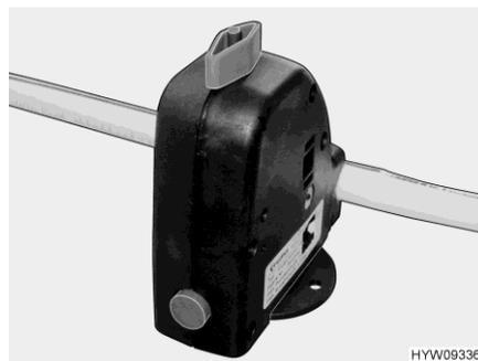
Bild 218 Sicherheits-/Ablassventil (Truma)
