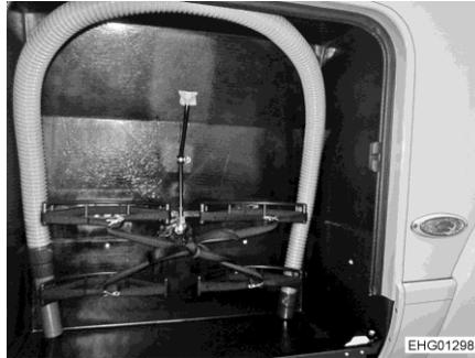
Bild 206 Abwasserschlauch (Gaskasten)
