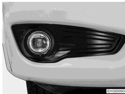
Bild 231 Kurvenlicht/Nebelscheinwerfer
