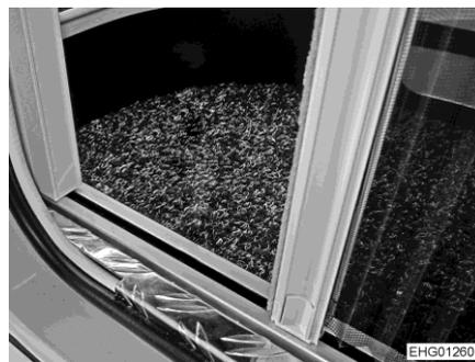
Bild 59 Insektenschutz (untere Füh- rung)
