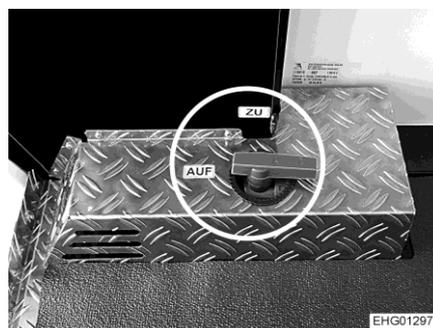
Bild 205 Bedienhebel (Ablasshahn)
