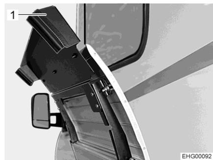
1 Blende, Außenklappe Gaskasten
