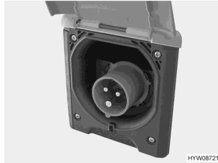
Bild 147 230-V-Anschluss am Fahrzeug (CEE-Steckdose)
