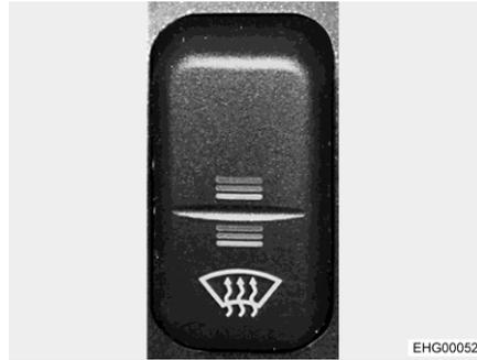
Bild 11 Wippschalter (Frontscheibenheizung)
