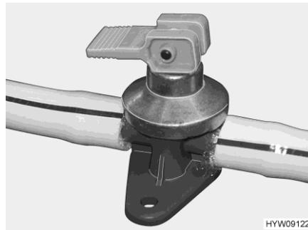
Bild 216 Ablasshahn (Boiler Alde)
