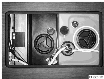
Bild 219 Reinigungsöffnung (Wassertank)
