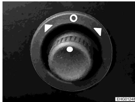
Bild 35 Schalter (elektrisch einstellbare Außenspiegel)
