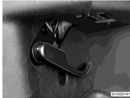
Bild 38 Entriegelungshebel Motorhaube
