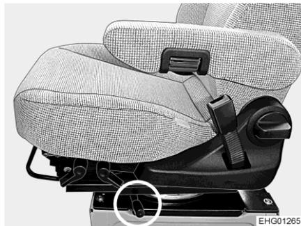
Bild 81 Hebel zum Drehen des Sitzes
