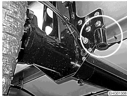
Bild 242 Aufnahme Hinterachse
