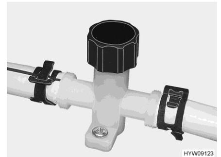
Bild 217 Ablasshahn (Wasserleitung)
