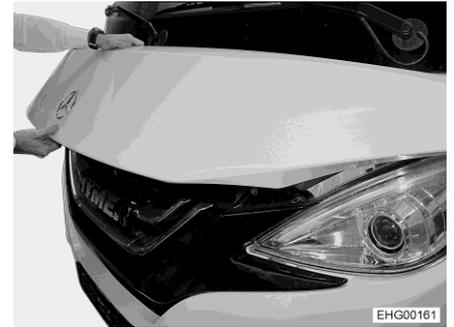
Bild 39 Korrekte Griffposition zum Öffnen der Motorhaube
