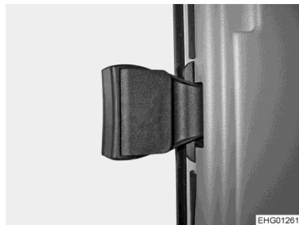
Bild 62 Griff zum Öffnen des Beifahrerfensters
