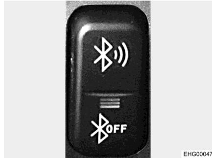
Bild 136 Wippschalter (Bluetooth-Anschluss)
