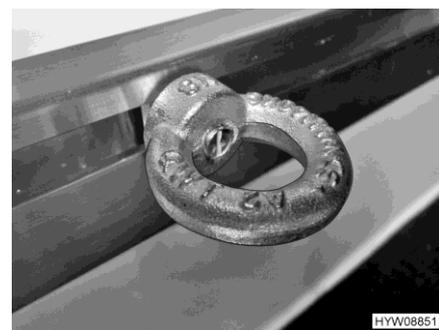
Bild 7 Verzurröse (geklemmt)
