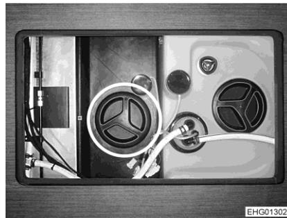
Bild 220 Reinigungsöffnung (Abwassertank)
