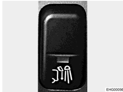
Bild 45 Wippschalter (Heckbereich-Beleuchtung)
