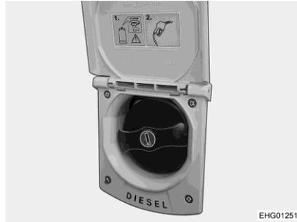
Bild 41 Kraftstoff-Einfüllstutzen
