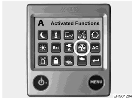
Bild 178 Booster-Funktion (Zusatzgebläse)
