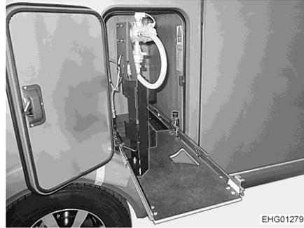
Bild 130 Gaskastenauszug in Wechselstellung
