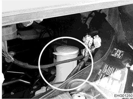
Bild 40 Einfüllstutzen (Waschwasserbehälter)
