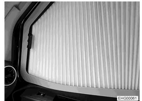
Bild 71 Faltverdunklung (Beifahrerfenster)
