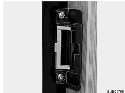
Bild 197 Verschlusseinrichtung (Lüftungsstellung)
