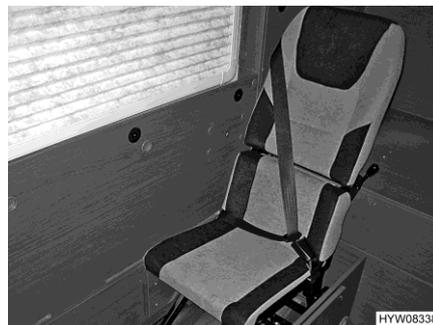
Bild 33 Einsatzbereiter Zusatzsitz
