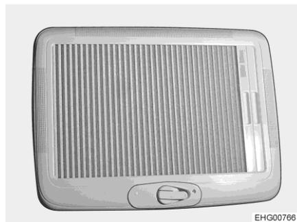
Bild 74 Dachhaube (Lamellenplissee geschlossen)
