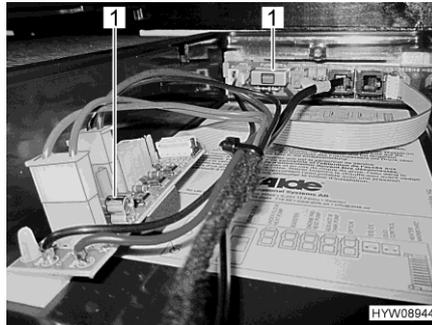
1 Glasrohrsicherung 3,5 A
