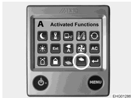
Bild 180 Funktion Motorheizung (Zusatzgebläse)
