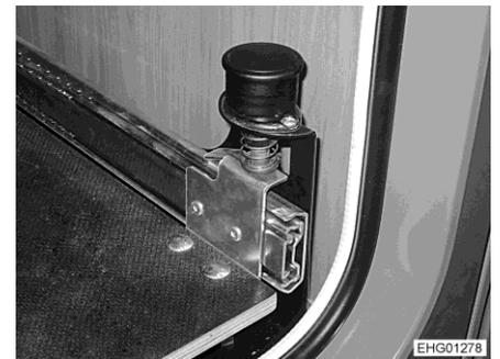
Bild 129 Knauf mit Arretierung
